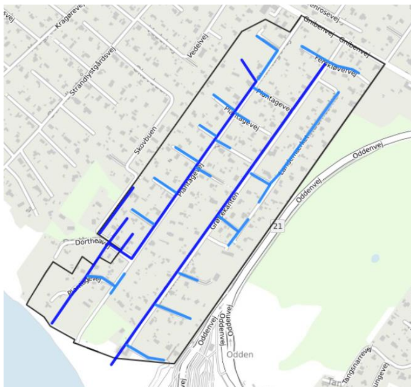
Figur 5.5: Forslag til placering af stik-grøfter i vejskel, som grundejer kan koble sig på /2/.
