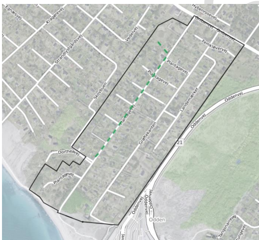
Figur 5.3: Foreslået placering af åben grøft langs Plantagevej /2/
