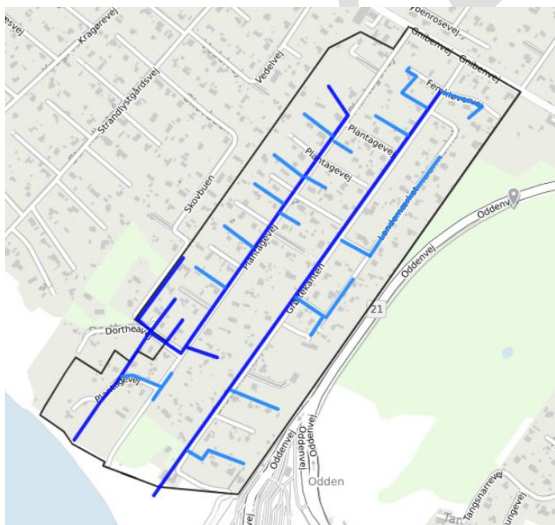
Figur 5.6: Alternativt forslag til placering af stik-grøfter i skel uden vej, som grundejer kan koble sig på /2/.
